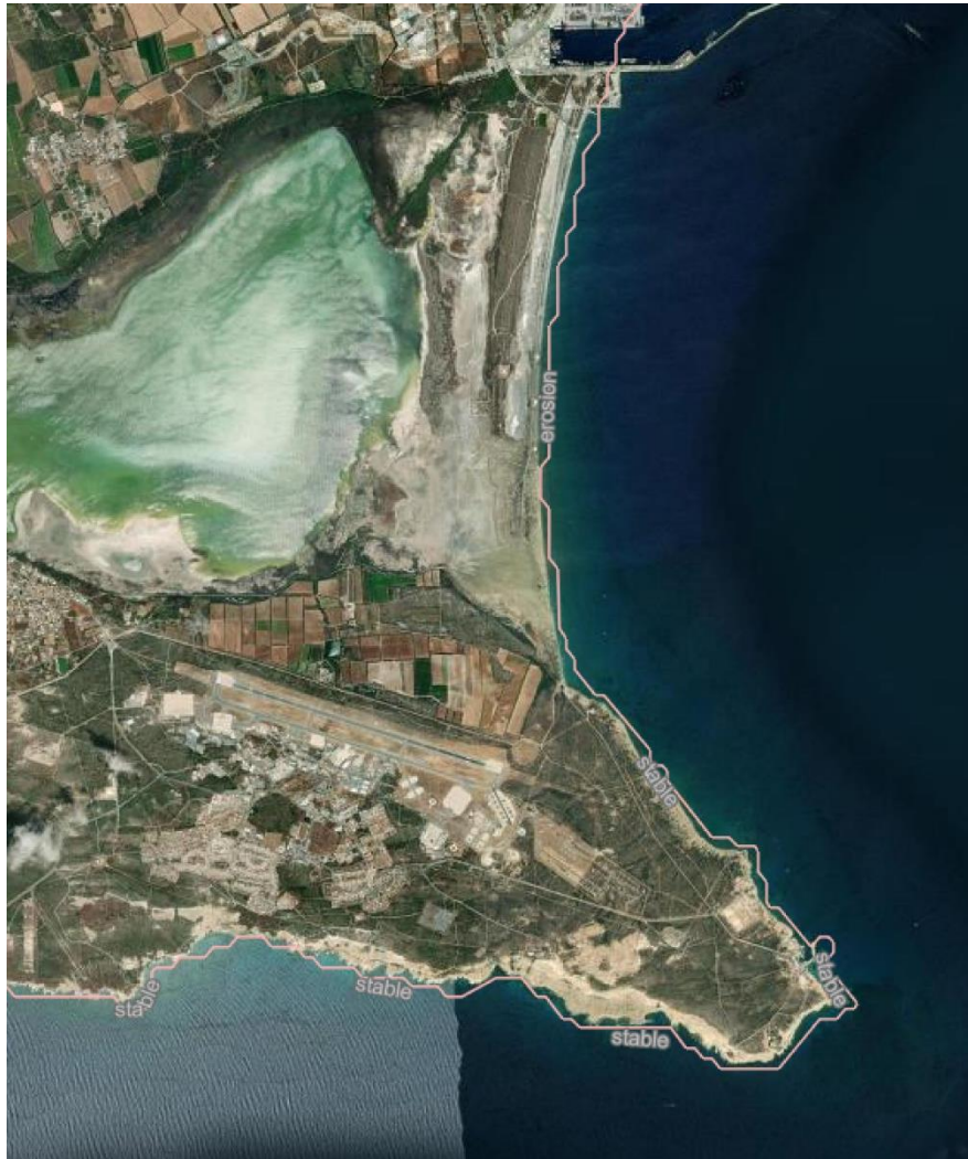
Εικόνα 7.23: Περιοχή Ακρωτηρίου - Η Παραλία του Lady's Mile χαρακτηρίζεται ως ευπαθείς σε θέματα διάβρωσης της ακτογραμμής ενώ η νότια ακτογραμμή του Ακρωτηρίου χαρακτηρίζεται ως σταθερή (Τ.Γ.Ε., 2023).
